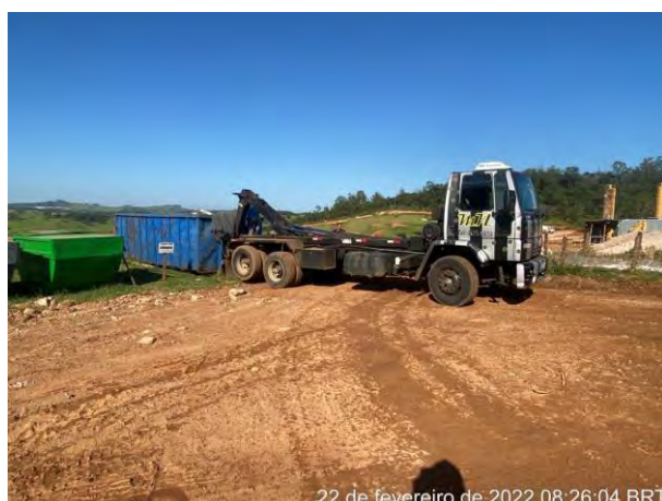
Foto 364 – Troca de caçambas de resíduos de metal do canteiro industrial. (Data:22/02/2022)
